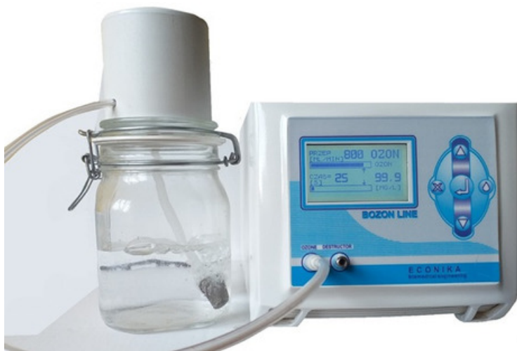
Rys. 1 Ozonowanie wody za pomocą ozonatora Bozon Line.
