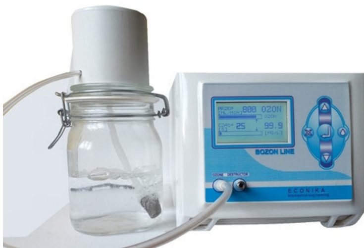
Rys. 1 Ozonowanie wody za pomocą ozonatora Bozon Line.
